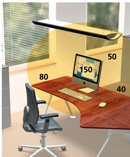
Zulässige Unterschiede der Flächenhelligkeiten bei richtiger Bildschirmaufstellung (die Zahlenwerte geben Leuchtdichten in \text{cd/m}^2 an)
